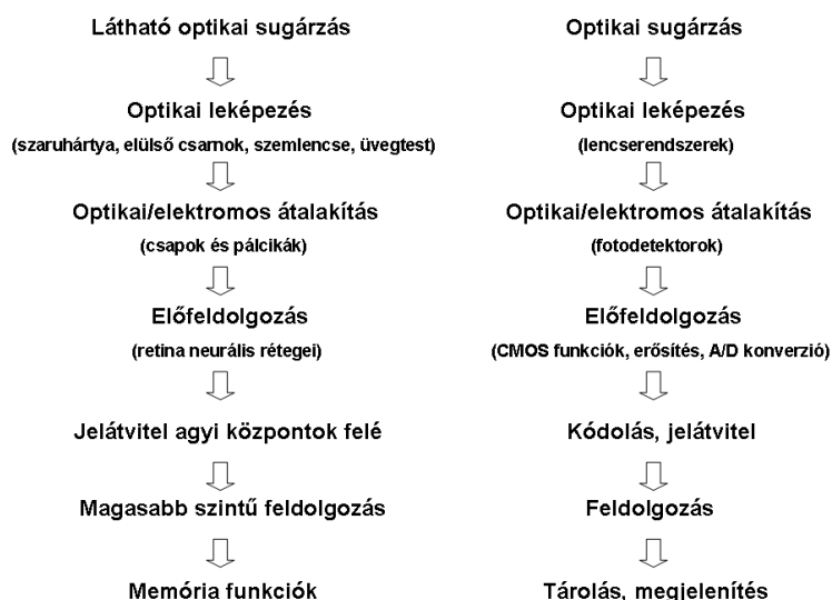
2.1. ábra. A vizuális információ feldolgozásának alapvető folyamatai az emberi látórendszerben és a gépi rendszerekben
