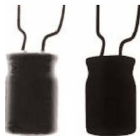
9.7. ábra. Kondenzátor képe normál háttérmegvilágítás és kollimátor használatával
