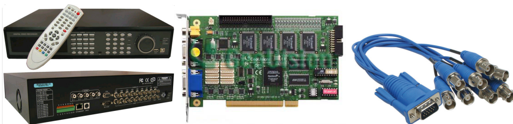
10.3. ábra. 8 csatornás DVR, 16 csatornás számítógépbe helyezhető PCI digitalizáló kártya és a hozzá való VGA-BNC átalakító
