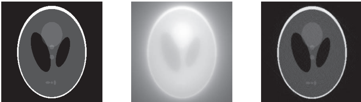
2.5. ábra. A már megismert Shepp-Logan fantom, rekonstruálása szűrő nélkül és ramp-szűrővel (balról jobbra).
