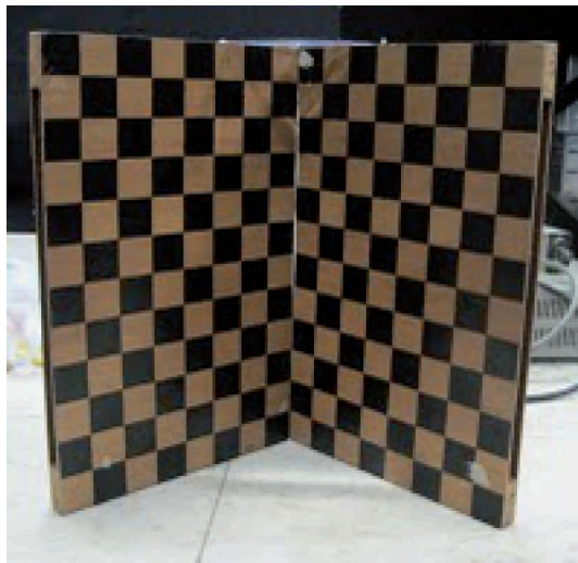
1.7. ábra. A leggyakrabban használt kalibrációs minta a Tsai rács
