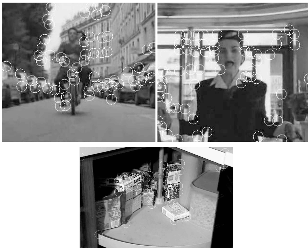
7.1. ábra. A KLT kimenete 3 különböző képre. Jól látható, hogy az élek találkozásánál lettek kijelölve pontok.
