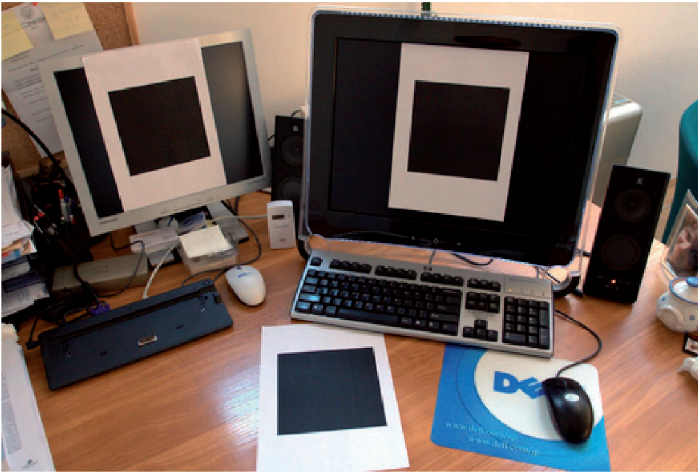
2.3. ábra. A projektív kép tulajdonságait kihasználva kalibrálhatjuk a kameránkat 3 nem egy síkba eső, de egyébként nem feltétlenül derékszögben elhelyezett négyzetről készített kép alapján.
