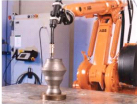
11.3. ábra. Maró, esztergáló robot az iparban
