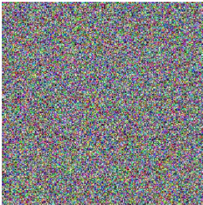
7. ábra 128 bites AES-el kódolt kép CBC üzemmódban
