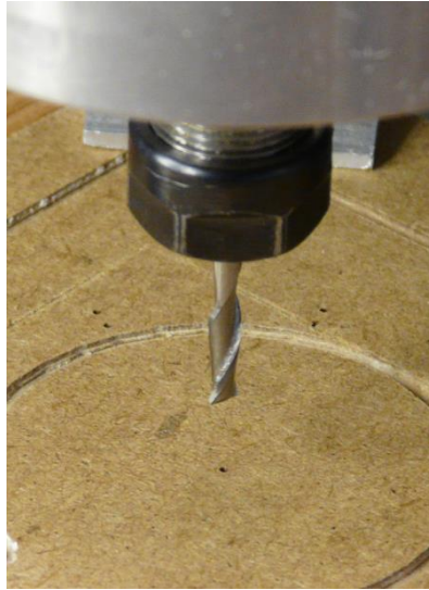
7.2.2.1. ábra: Szerszám a munkadarab origójában
