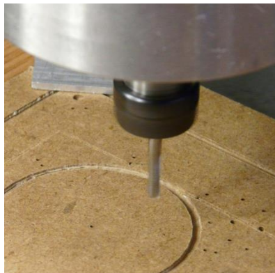
7.2.2.2. ábra: Bekapcsolt főorsóval megközelített munkadarab
