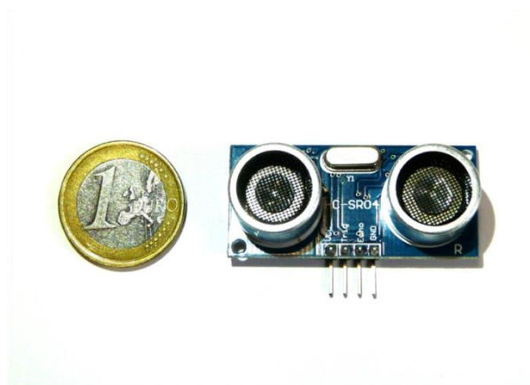
4.24. ábra: Ultrahangos detektor működése és fényképe
