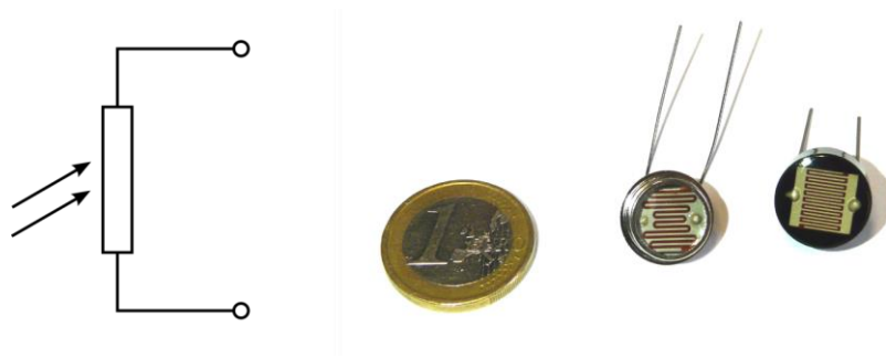
4.15. ábra: Fotoellenállás áramköri rajza és fényképe
