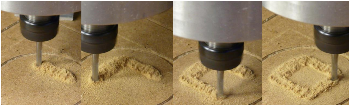
7.2.2.4. ábra: Szerszám mozgatása a munkadarabban
