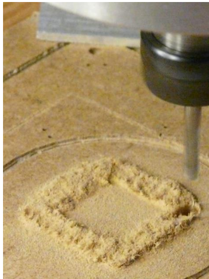
7.2.2.5. ábra: Szerszám kiemelése a marás végeztével
