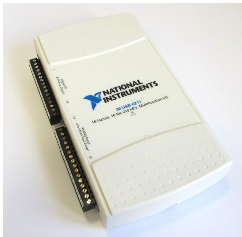
Fig. 28. The NI USB 6211 multifunction instrument
