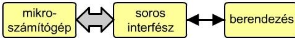
6.8. ábra. Eszköz csatlakoztatása soros interfésszel a mikroszámítógéphez.
