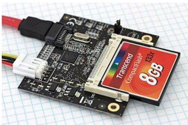
9.8. ábra. COMPACT FLASH memóriakártya beágyazott rendszeren.
