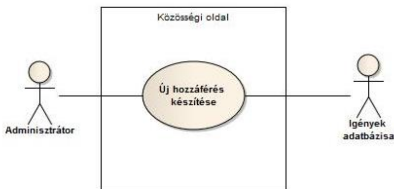
9. ábra: A használati eset diagram frissítése az Igények adatbázisa aktor hozzáadásával
