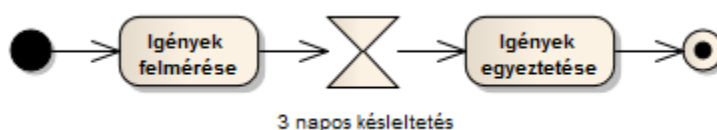
31. ábra: Az ábrán megjelenített időesemény 3 napos várakozási időt jelöl a két művelet között.
