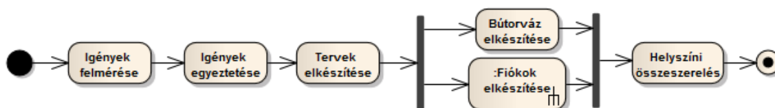
33. ábra: A tevékenységdiagram egyszerűsített formában. Javítja az olvashatóságot a tevékenység meghívása.
